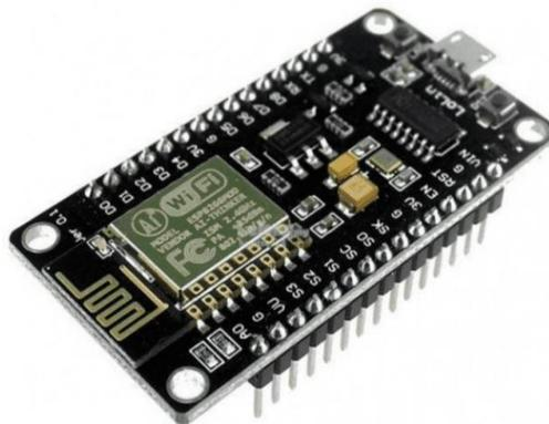
Gambar 1. Desain Modul ESP8266 untuk Replikasi Jaringan Wi-Fi.
