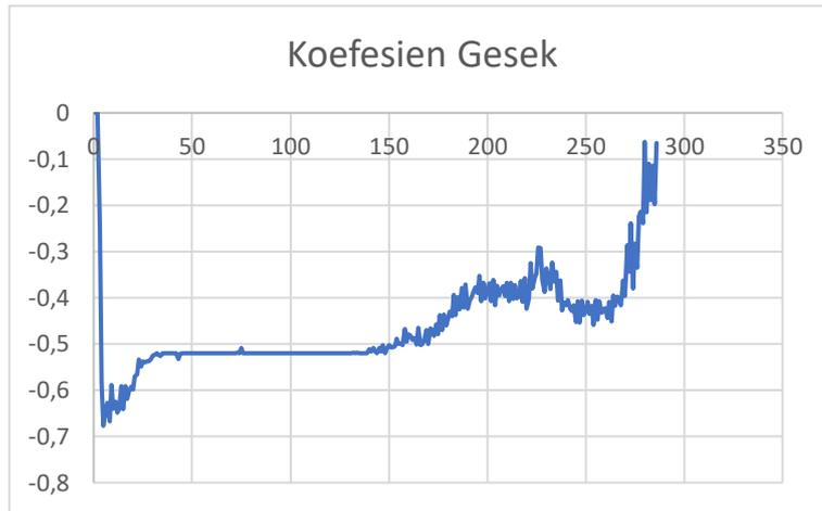
Gambar 3. grafik koefesien gesek tanpa *coating* pengujian ketiga.
