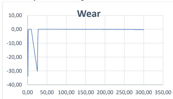
Gambar 3.17 grafik wear 1 lapisan coating percobaan kedua.
