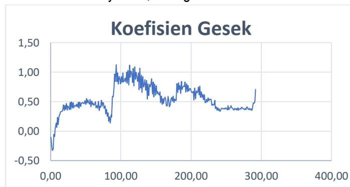
Gambar 3.15 grafik koefisien gesek 1 lapisan coating percobaan ketiga.
